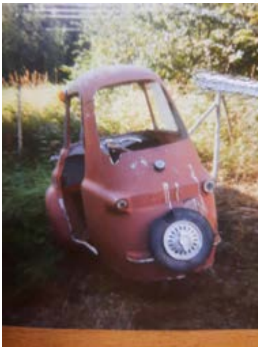
Her ser vi at ein Scootacar berre har ei dør og at dette objektet mangla baklys, som det ikkje finst reserve av lenger.
